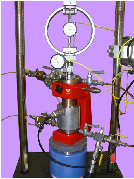
Fig. 2. Photo de l'œdomètre K_0 à haute pression installé sur une presse triaxiale.
