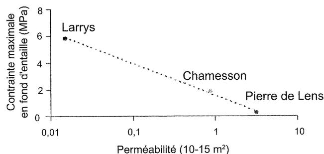
FIG. 9 Valeur maximale de la contrainte en fond d'entaille en fonction de la perméabilité pour les trois calcaires testés.
