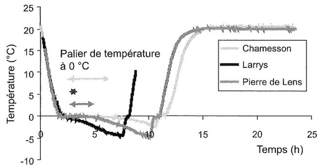
FIG. 5 Variation de la température (°C) en fond d'entaille de chacun des trois cubes calcaires testés au cours d'un cycle de gel-dégel.
