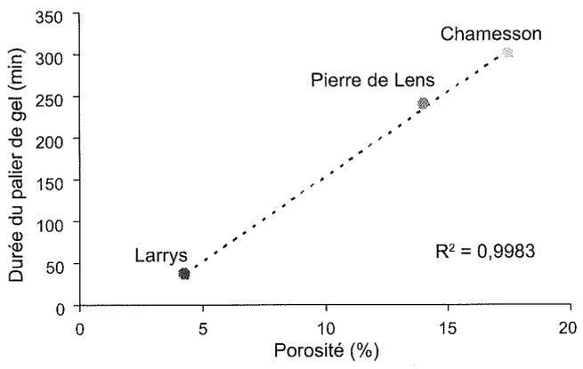
**FIG. 6** Durée du palier de gel à 0 °C en fonction de la porosité du calcaire testé.
