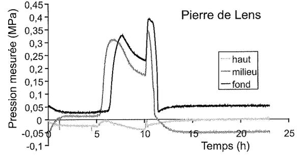
**FIG. 7** Allure de la température et de la contrainte (MPa) mesurées en différentes profondeurs de l'entaille au cours d'un cycle de gel-dégel pour les trois calcaires.
