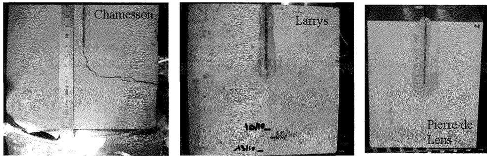
FIG. 4 Prolongement de l'entaille en fissure suite aux cycles de gel-dégel, pour les trois calcaires testés.
