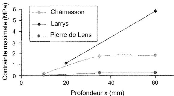
FIG. 8 Allure de la contrainte maximale (MPa) en fonction de la profondeur de mesure, x (mm).
