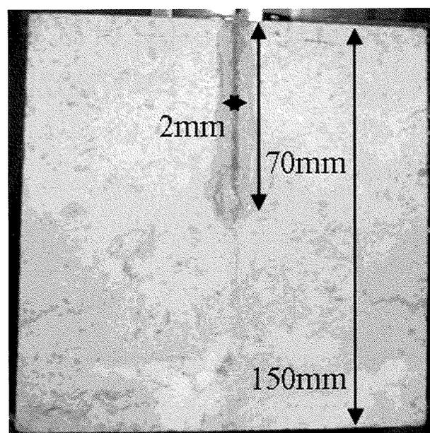
FIG. 2 Dimensions des éprouvettes de calcaires entaillées.
