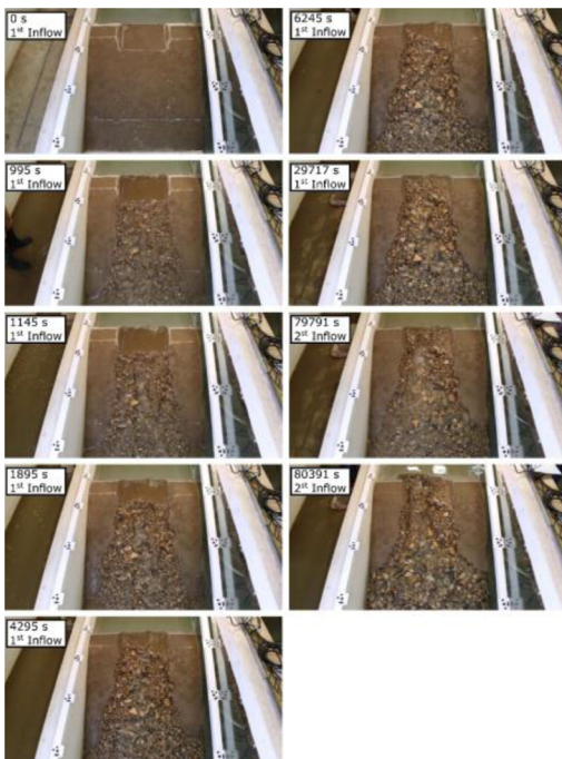
Fig. 4. Essai de surverse du remblai en matériau de Montfaucon. Fig. 4. Overflow test on the Montfaucon embankment.
